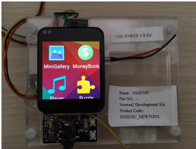
Slika 1. Tizen 2.3 wearable operativni sistem na Newton2 platformi
