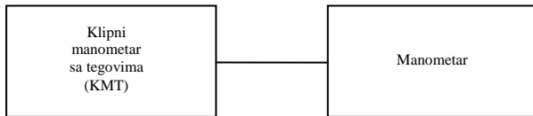
Sl. 5. Blok-šema za etaloniranje manometra
