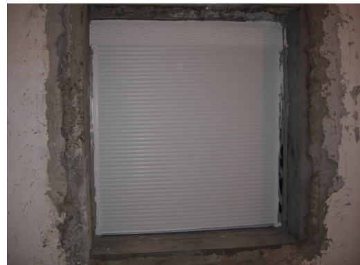
Sl. 8. Prozor koji je bio predmet ispitivanja ugrađen u laboratoriji: sa podignutom roletnom (gore) i sa spušenom roletnom (dole).
