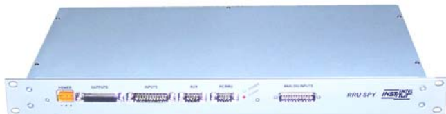
Slika 1. Izgled RRU SPY jedinice za montažu u 19" rek
