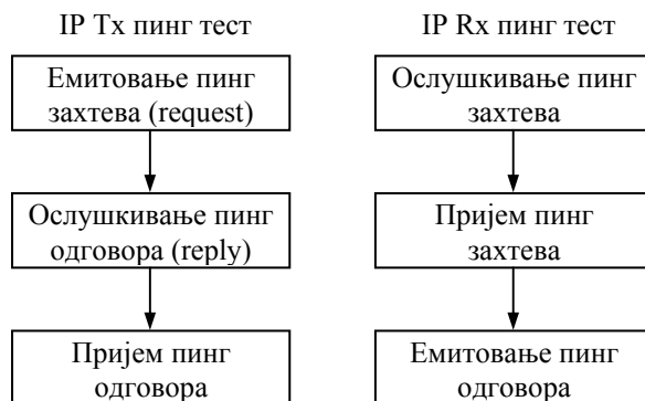
Сл.3. Принцип IP Tx и IP Rx пинг теста
