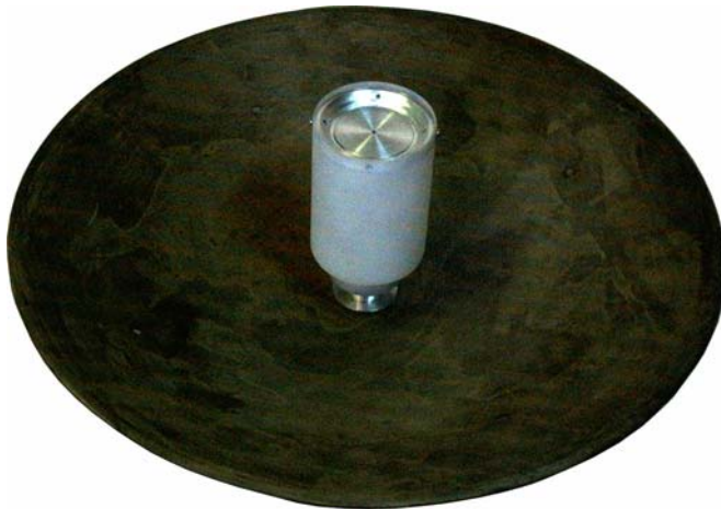
Slika 1. Antena pre farbanja kompozitnog reflektora poliuretanskom plastičnom farbom
