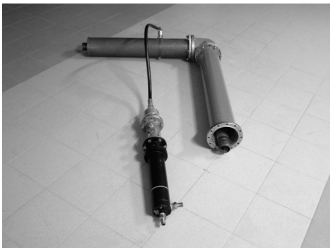
Сл.2. Фотографија водом хлађеног 50 \Omega / 40 kW отпорника повезаног са уздужно разрезаним коаксијалним водом спојеним за тестирање излазног и побудног РФ-појачавача.
