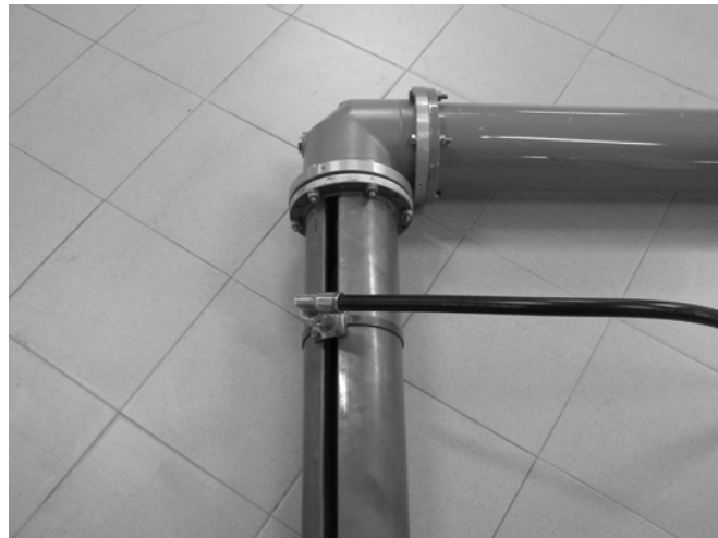
Сл.3. Детаљ споја стандардних елемената коаксијалног вода карактеристичне импедансе 50 \Omega , колена и линије дужине 1 m, настављених уздужно разрезаним коаксијалним водом исте импедансе.
