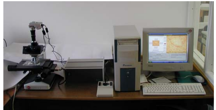
Slika 1. Povezan sistem: mikroskop sa motorizovanim postoljem i kamerom (levo), kontroler platforme sa džojstikom (u sredini) i računar (desno).
