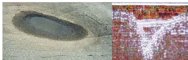
Sl. 5. Detekcija curenja cevovoda
