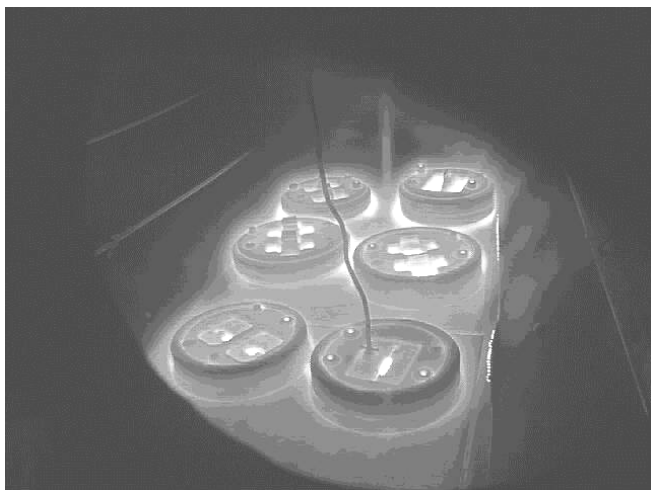
Slika 1 Efekat "šuplje katode" u uskim procepima radnih komada u procesu plazma nitriranja
