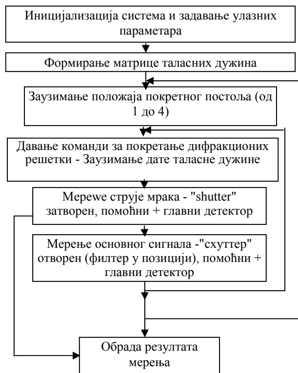
Слика 2 конфигурација система за мерење спектралне пропустљивости
