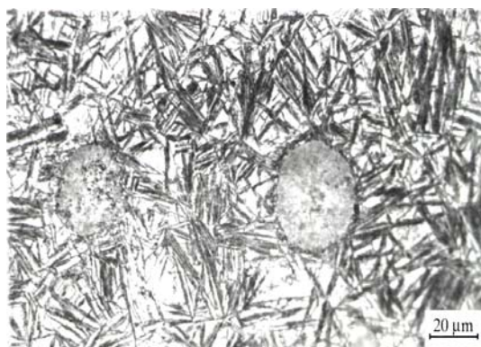
Sl. 2. Mikrostruktura osnove CuNiMo nodularnog liva posle austemperovanja na 320 °C 2,5 h.
