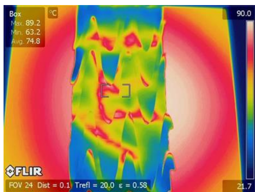
Slika 5. Prosečna temperatura označene površine zelenog dela pletene mreže i odgovarajući faktor emisivnosti
