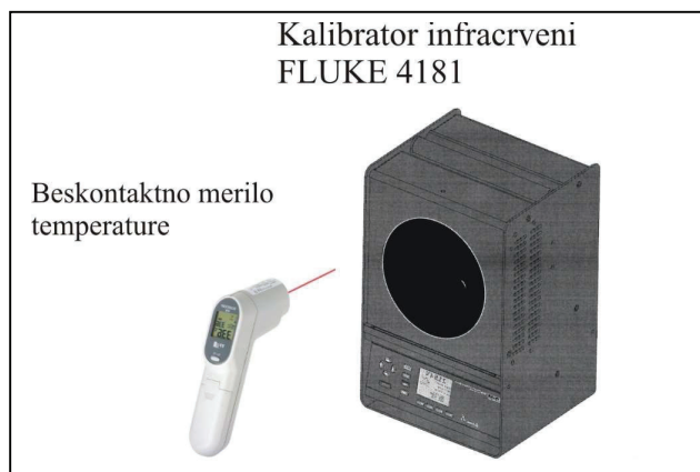
Slika 1. Prikaz metode etaloniranja beskontaktnih infracrvenih merila temperature.
