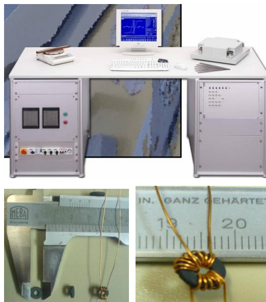
Сл. 4. Хистерезиограф Brockhaus Tester MPG 100 D за снимање B-H хистерезисних кривих на узорцима MnZn ферита у облика торуса.
