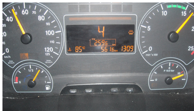
Sl. 4. Prikaz kontrolne table pri ispitivanju imunosti na radijacione smetnje.
