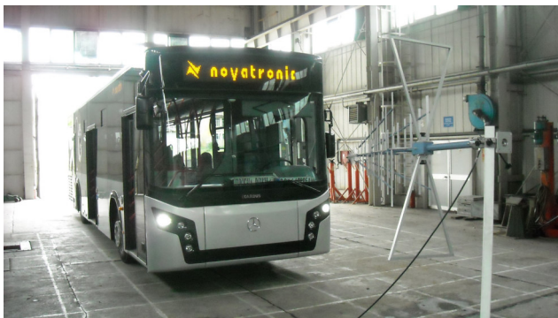
Sl. 2. Merenje radijacione uskopojasne elektromagnetske emisije sa prednje strane autobusa IK113.
