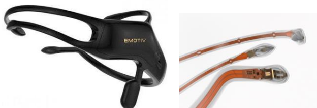
Sl. 3. „EMOTIV Insight“ EEG uređaj (levo) i izgled polusivih polimernih elektroda (desno)
