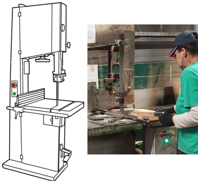
Sl. 1. Vertikalna tračna testera koja se koristi za dodatnu ručnu obradu drveta. Levo je prikazan crtež cele mašine a desno je prikazana fotografija jedne takve mašine u toku rada.
