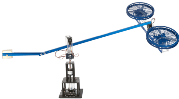
Sl. 1. Slika laboratorijske makete helikoptera kompanije Quanser [1]
