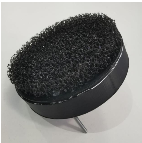
Sl. 7 Realizovani mikrofonski modul sa EMI kućištem i zaštitom od vetra ( wind shield )
