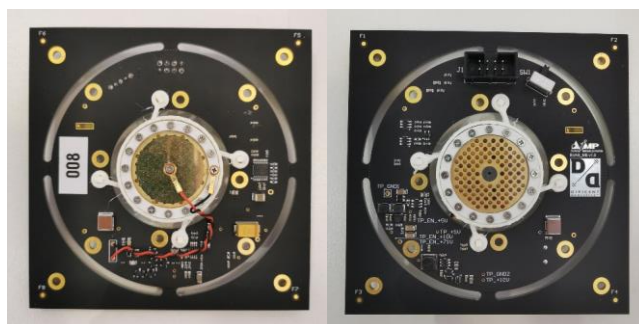
Sl. 5 Realizovani mikrofonski modul
