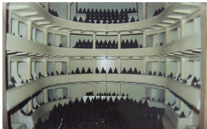
Sl. 3. Fizički model sale Narodnog pozorišta u Beogradu u razmeri 1:10, napravljen u Laboratoriji za akustiku 1988. godine. [6].
