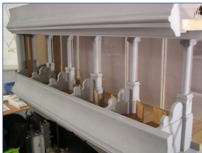
Sl. 10. Dva parcijalna modela koji predstavljaju delove istorijske sale opere u Ljubljani napravljena u razmeri 1:10: portal sa ložama (gore), segment loža iz sale (dole); na prosceniju se vidi varničar, a ispred je raster za pozicioniranje mikrofona.
