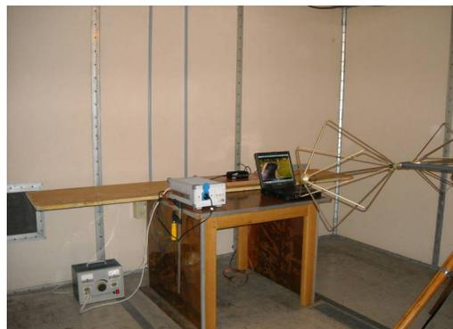
Sl. 1. Ispitivanje nivoa električnog polja EM smetnji.
