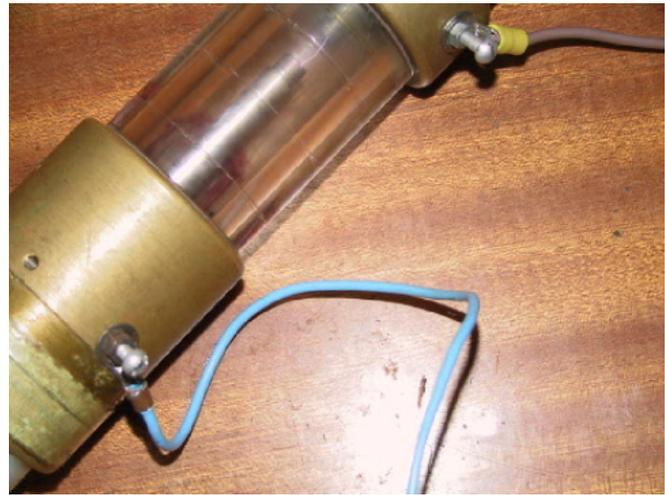
Slika 8: Fleksibilni model gasnog odvodnika prenapona
