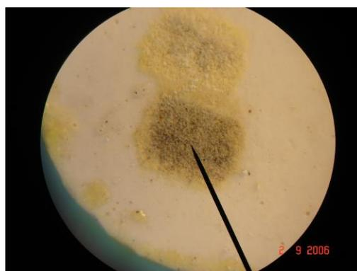
Slika 4. Mikrograf analize optičkim mikroskopom belog gipsa izloženog laserskom snopu. (Nd<sup>3+</sup>:YAG, E = 35 mJ, površinski reljef, OM 40 x)
