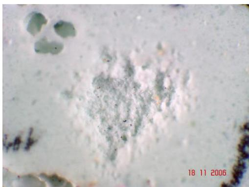
Slika 6. Fotomikrograf povrede na uzorku HAP-a. (Nd<sup>3+</sup>:YAG, Q-switch, E = 35 mJ, površinska modulacija, OM 40 x)
