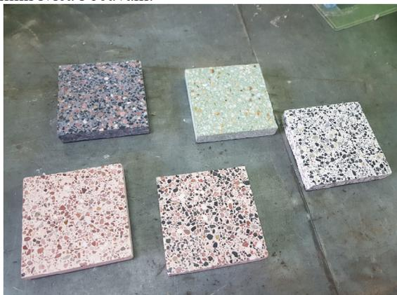
Slika 2: Ispitivani uzorci keramičkih materijala za oblaganje
