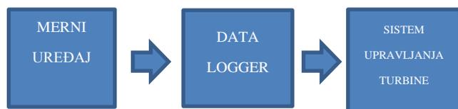
Sl. 1. Blok dijagram mernog sistema vetroturbine
